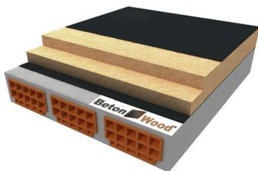
Sistema completo a secco per solai con pannelli in fibra di legno densità 200 kg/m<sup>3</sup> FiberTherm roof su laterocemento. Ottimo sistema per isolamento termo-acustico di solai non calpestabili.
