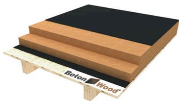
Sistema completo a secco per solai con pannelli in fibra di legno densità 160 kg/m<sup>3</sup> FiberTherm su X-lam.
