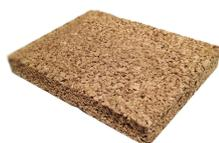
**Cork Panels plus** è un pannello in sughero biondo supercompresso caratterizzato da ottimi valori di isolamento termico e di traspirabilità, che riducono la formazione di muffe e di umidità rispetto ai prodotti tradizionali; garantisce un ottimo abbattimento acustico, ed è il prodotto ideale per la realizzazione di pavimenti anticalpestio dei solai interpiano, grazie anche alla sua alta resistenza a compressione.
