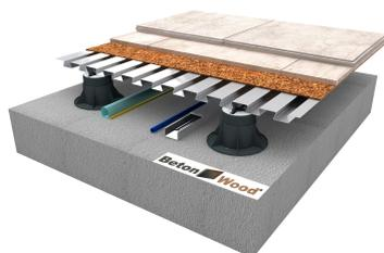
Sistema completo per pavimenti e solai sopraelevati con pannelli di irrigidimento BetonWood TG, Betonwood, isolante sottile in sughero e lamiera a coda di rondine
